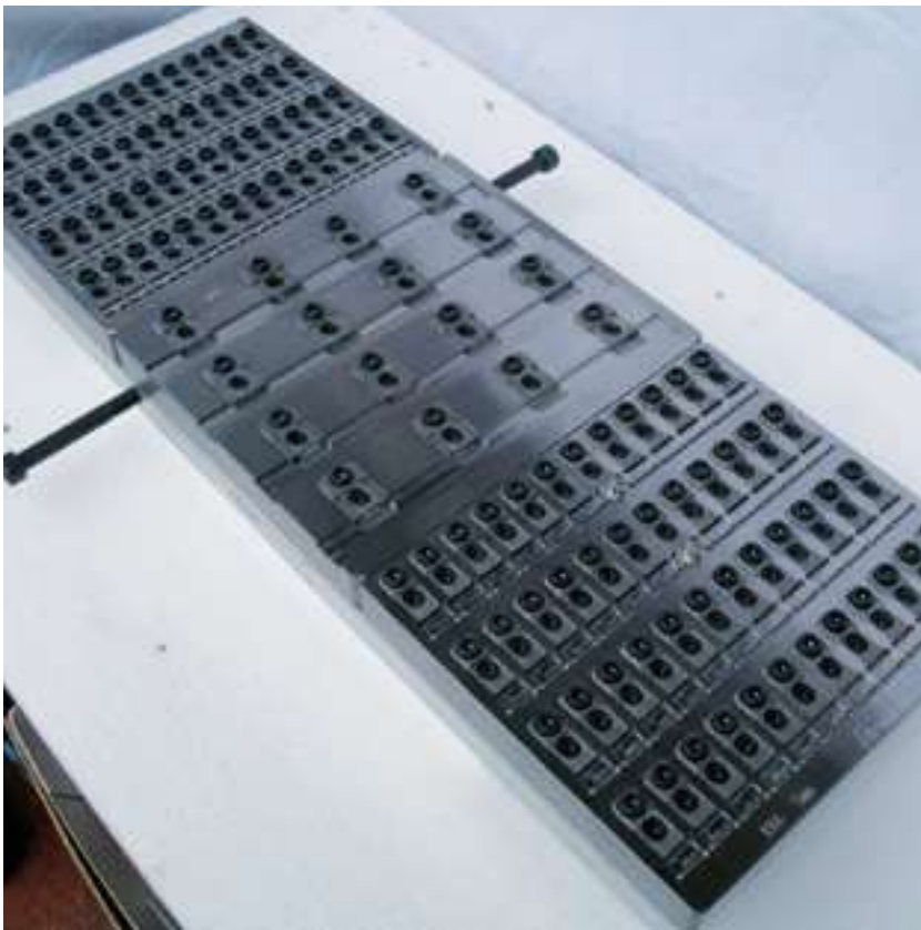
用于小零件多个夹紧的机械装配。 Dispositif mécanique pour le serrage multiple de petites pièces. Mechanical assembly for multiple clamping of small parts.
