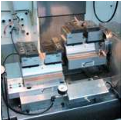
气动夹紧总成与第四轴相连。 Dispositif de serrage pneumatique associé à un 4 e axe. Pneumatic clamping assembly in connection with a 4th axis.
