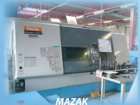
MAZAK Integrex 300 SY 2 broches 5 axes
